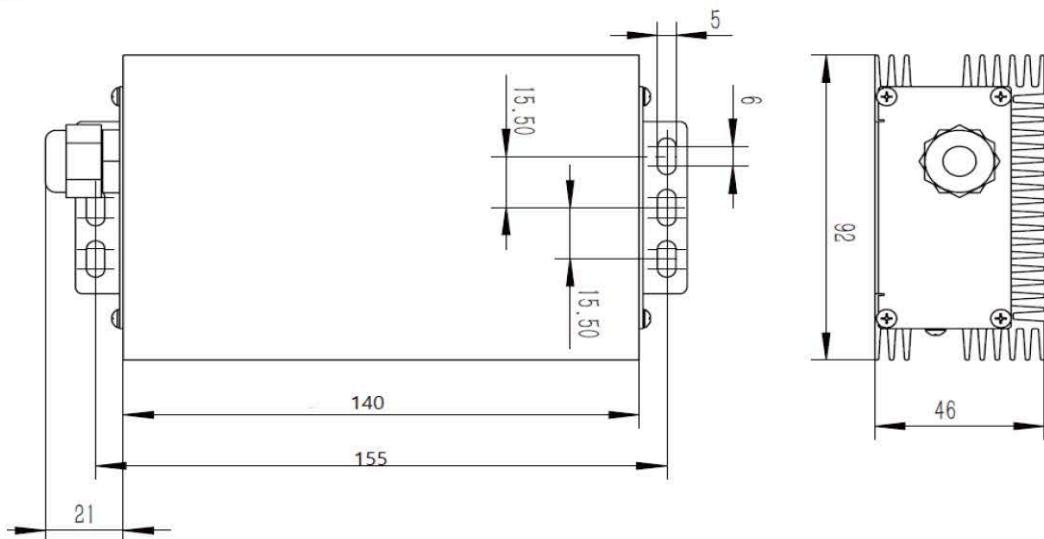
注：应安装于散热条件良好的空间，长时间满载/重载应用须保证使底面与其他金属面接触良好，以利热传导。
